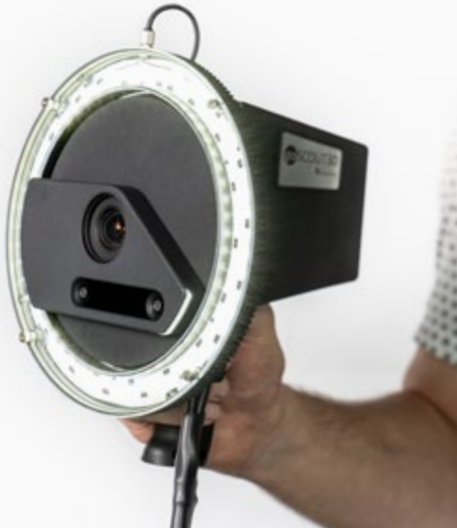
[2] 3D-Sensor mit aktivierten Ringlicht. / 3D sensor with activated ringlight
