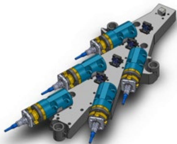
[3] CAD-Modell der spektralen Kombinationseinheit für fünf Kanäle fasergekoppelte Kanalquellen. / CAD model of spectral combination unit for five channels fiber coupled channel sources.
