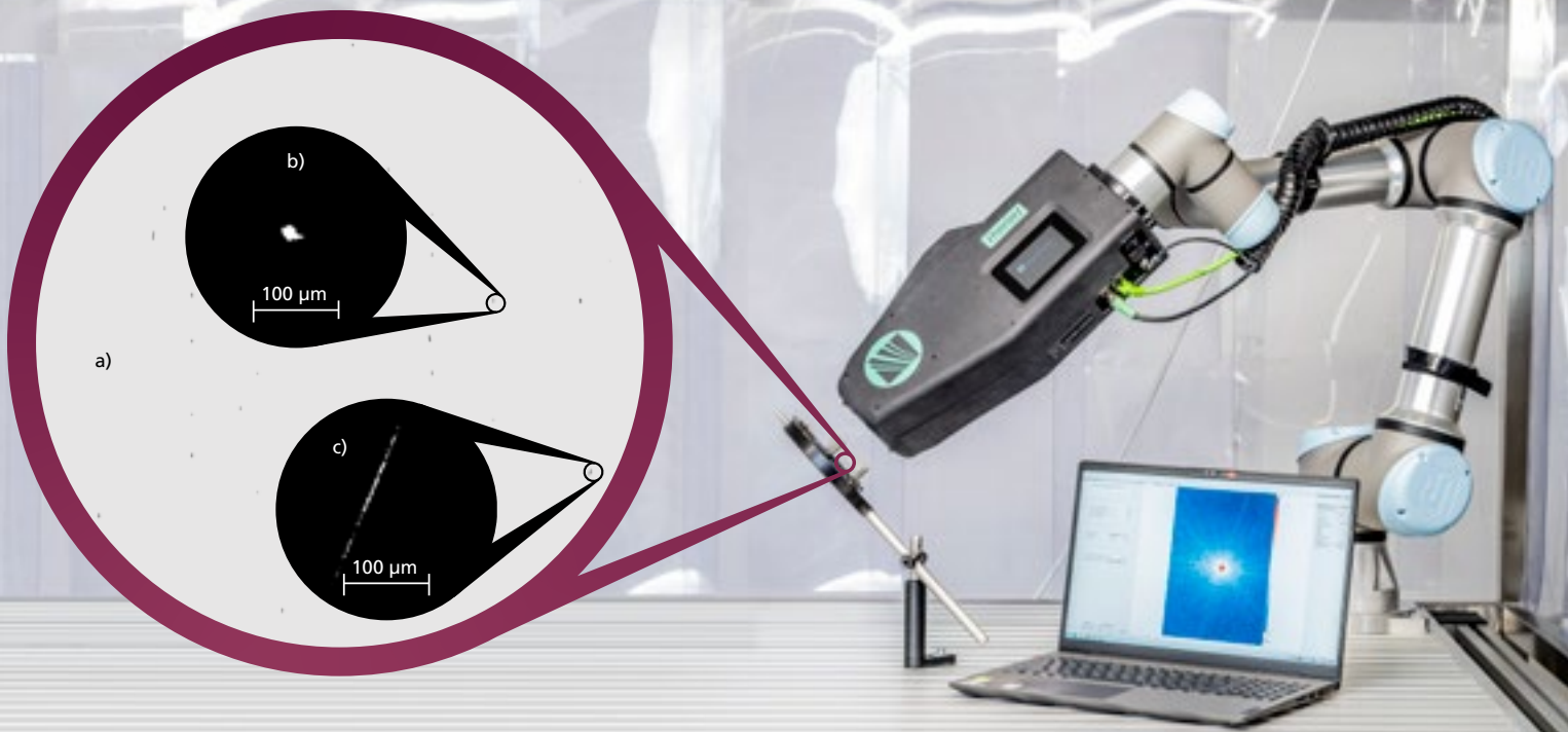
[1] Rauheits- und Defektsensor für Freiformoberflächen mit Partikel-/Defektkarte (a) sowie Mikroskopbildern (b,c) eines Metallspiegels (120x70 mm 2 ). / Roughness and defect sensor for freeform surfaces with particle/defect map (a) and microscopy images (b,c) of a metal mirror (120x70 mm 2 ).
