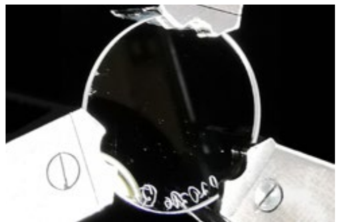
[2] Gemessene Reflexion einer Saphir Testscheibe mit AR-Coating vor und nach 300/500 Beanspruchungszyklen Desinfektion und Sterilisation (links), Testscheibe nach 500 Beanspruchungszyklen (rechts). / Reflection of a sapphire test sample coated with AR coating, measured before and after 300/500 disinfection and sterilization cycles (left), photo of the sapphire sample after 500 cycles (right).
