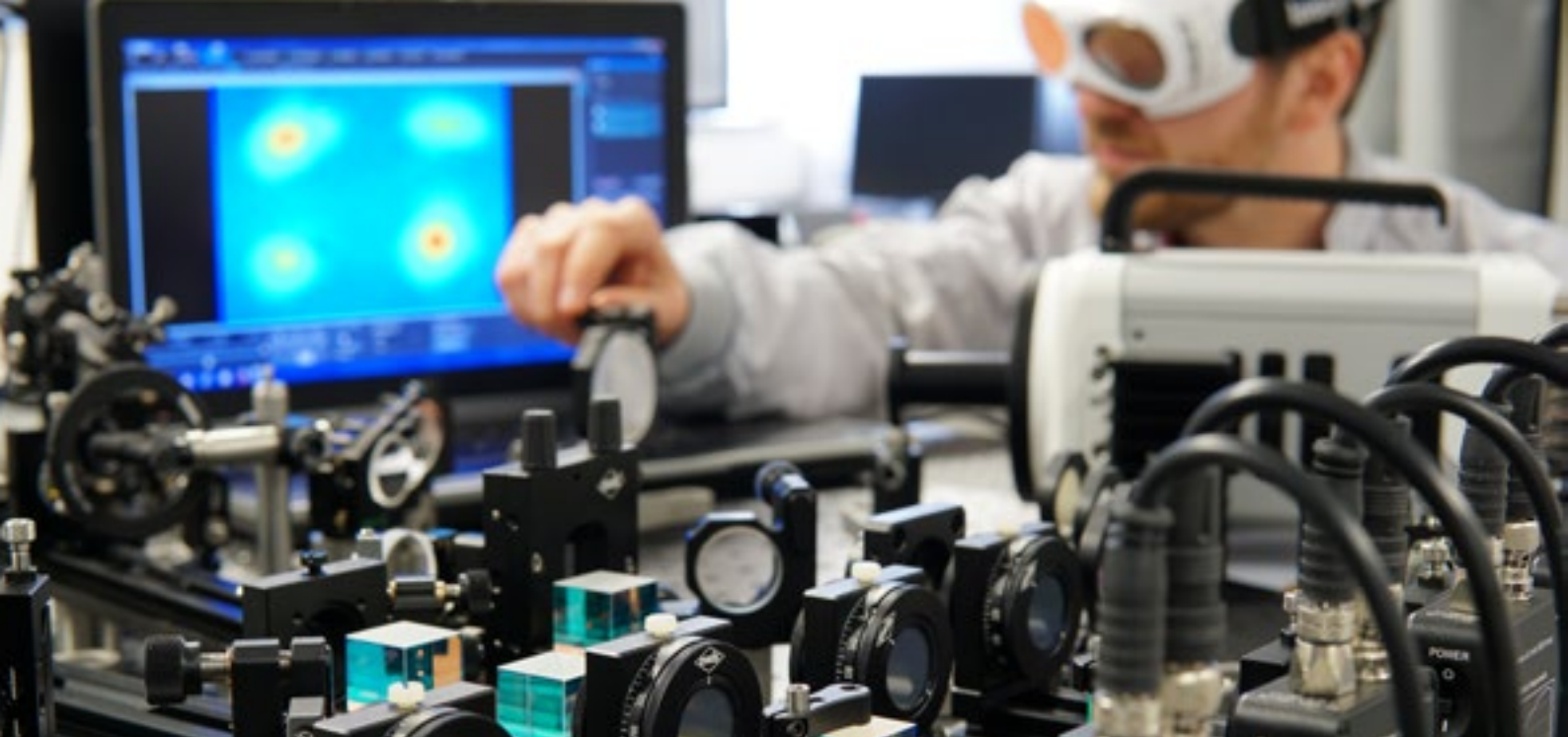
[1] Strahlauflteilung in vier Messkanäle, welche simultan von Photodioden und einer Hochgeschwindigkeitskamera detektiert werden. / Division-of-amplitude polarisation detection with four channels simultaneously measured by photodiodes and a high-speed camera.
