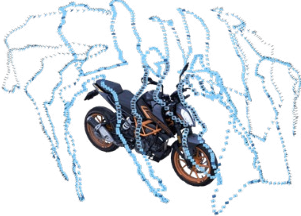
[1] Rekonstruiertes 3D-Modell eines Motorrads und zugehörige Trajektorie der Aufnahmebewegung. / Reconstructed 3D model of a motorcycle and associated trajectory of capturing motion.
