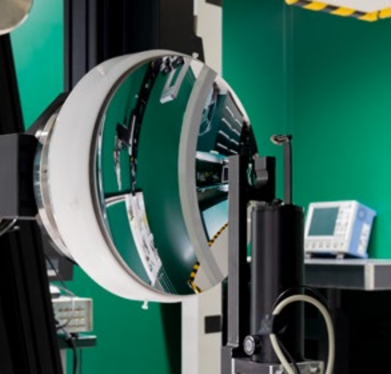
[2] Aufbau zur Messung der winkelaufgelösten Streuung (ARS). Setup for measuring angle resolved scattering (ARS).
